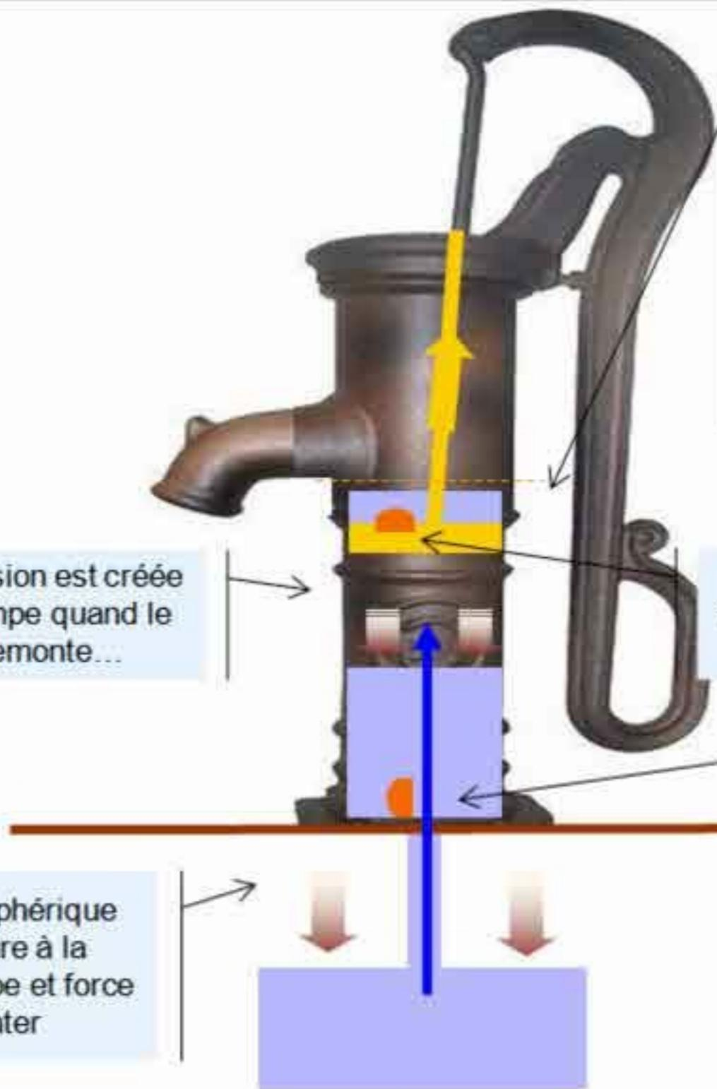
Le piston ne remonte pas plus haut que cette limite pour éviter que de l'air ne rentre sous le piston. La pression de l'air sous le piston augmenterait et l'eau redescendrait dans la colonne
